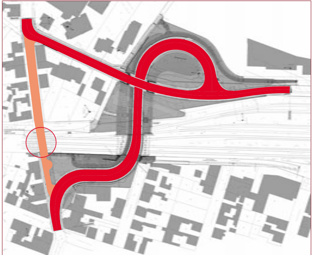
Um die nötige Tiefe unter den Bahngleisen zu gewinnen, wird die Wickerer Straße nach Osten verschwenkt und mündet dann in den Höllweg.
